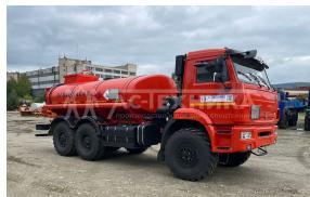
[Автотопливозаправщик АТЗ-12/2 на шасси КАМАЗ 43118-50](#)
