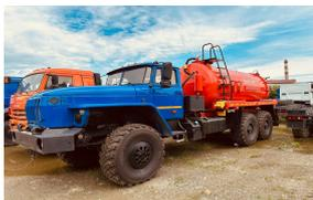
[Ассенизаторская машина КО-505 объемом 10 м3 на шасси Урал 4320-60](#)
