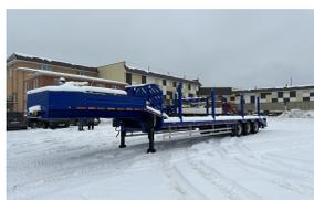
[Полуприцеп-тяжеловоз 9179-0000030 \(41 т, трапы уголкивые\)](#)
