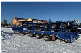
[Полуприцеп-тяжеловоз 9179-0000030 \(40 т, трапы уголкового\)](#)
