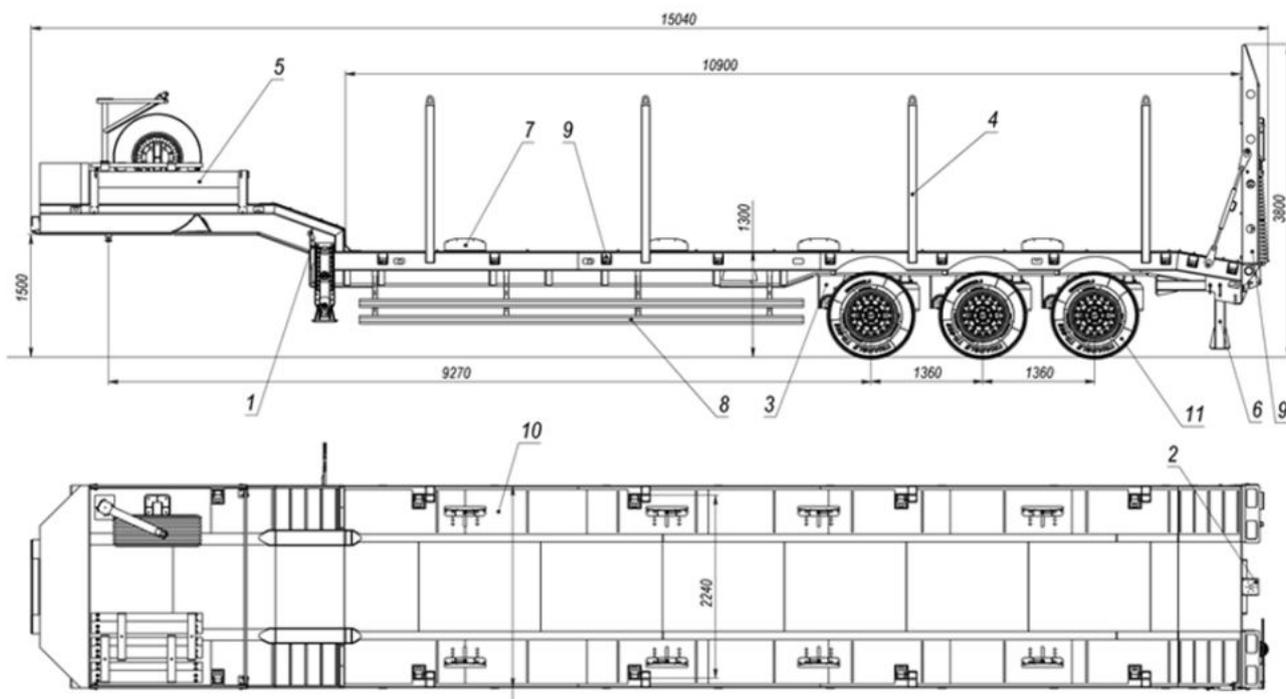
\*- Размеры полуприцепа при полной массе
